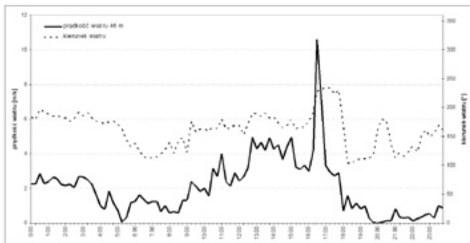
Ryc 3. Dobowy wykres kierunku wiatru oraz jego prędkości na wysokości 46 m z dnia 08.05.2009
