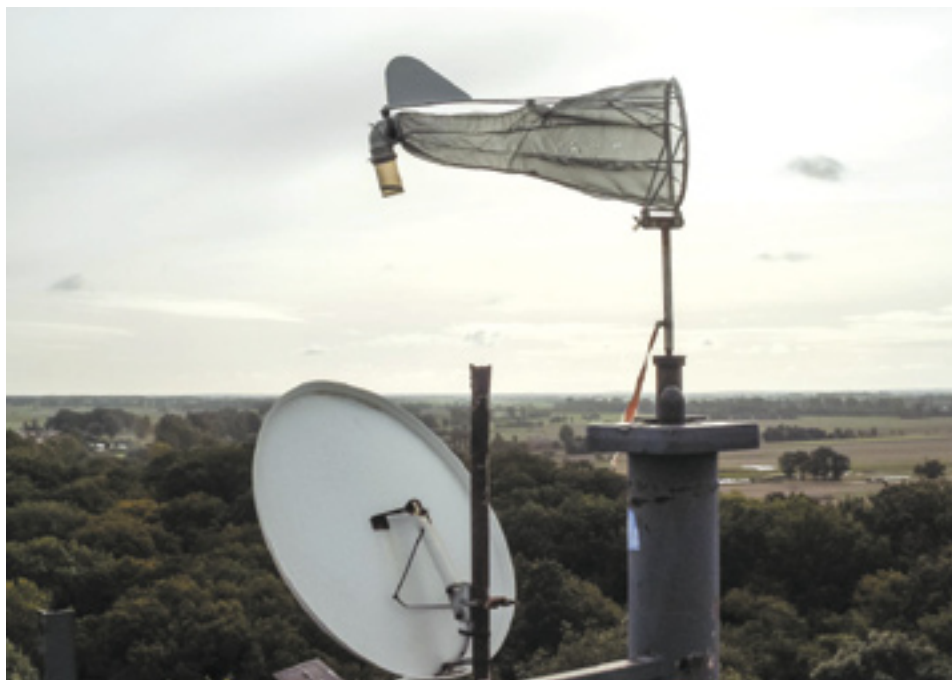
Fot 3. Obrotowy czerpak na szczycie wieży służący do biernego łowienia owadów (fot. J. Karg)
