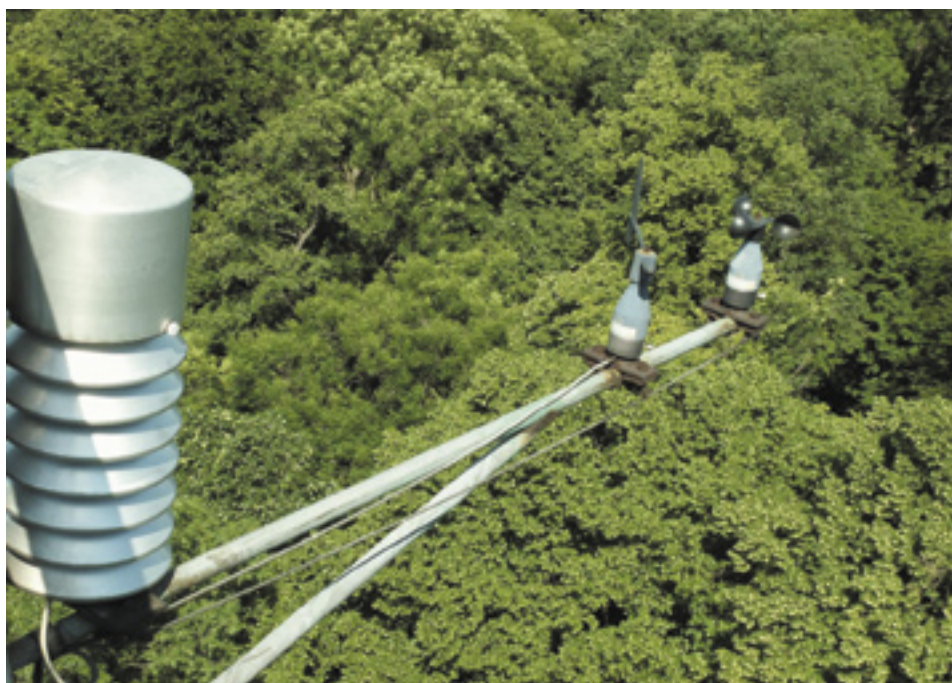
Fot 2. Zestaw czujników meteorologicznych na wysokości 46 metrów (fot. J. Karg)
