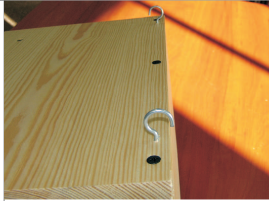
10. Haczyki wkręcamy tak, aby gwint ukrył się w desce na około 3-5 mm poniżej jej powierzchni. To gwarantuje, że nie złamie się on podczas zaginania
