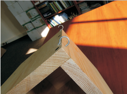
11. Po wkręceniu haczyki zaginamy tak aby (patrząc od przodu) jeden zagięty do przodu, drugi do tyłu. Chodzi o to, że gdy budka po zawieszeniu będzie się huścić to nie spadnie.
