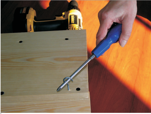
9. Haczyki do wieszania wkręcamy pomagając sobie przełożonym przez ucho śrubokrętem.
